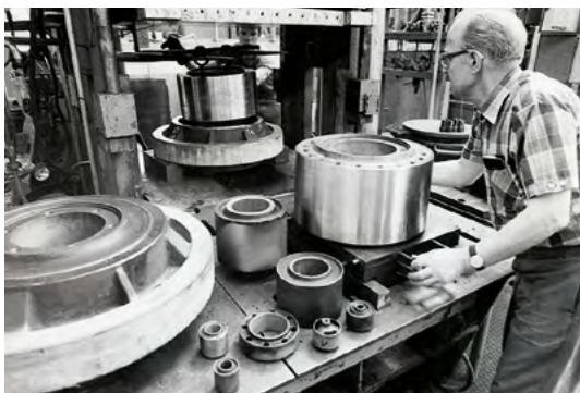
Fertigung von schwingungstechnischen Ultrabuchsen, 1957
