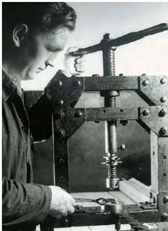
Herstellung der ersten Dichtungen auf einer Spindelpresse, 1929
